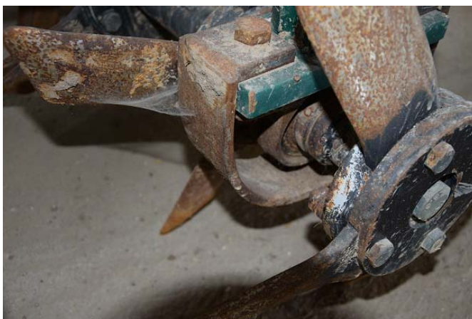
Rys. 10.7 Smarowniczka na łożyskach kolczatki
