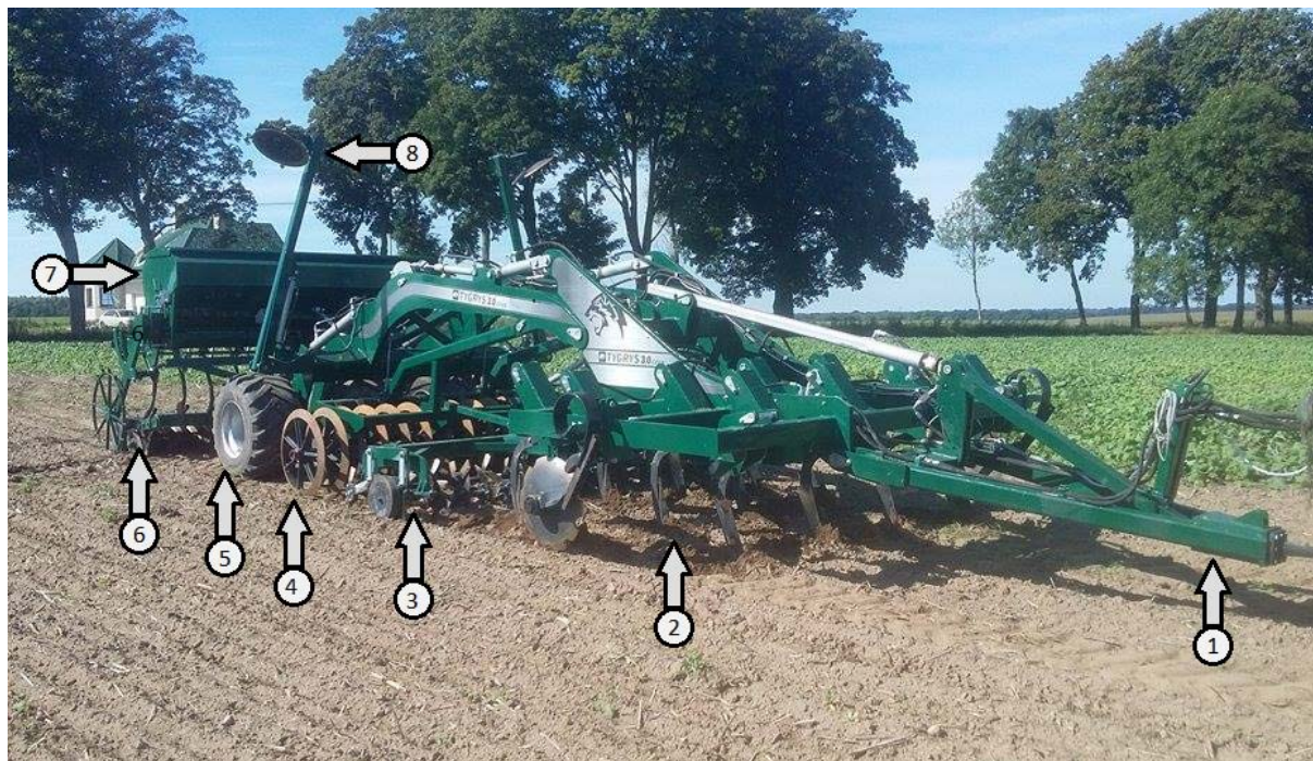
Rys. 5.9 Budowa agregatu uprawowo-siewnego Tygrys 3 GTWS z kolczatką i wałem oponowym dwu-rzędowym
