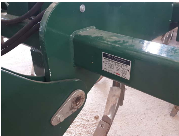
Rys. 2.2 Umieszczenie tabliczki na maszynie
