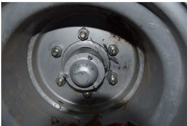
Rys. 10.11 Smarowniczka na piastach kół wału transportowego
