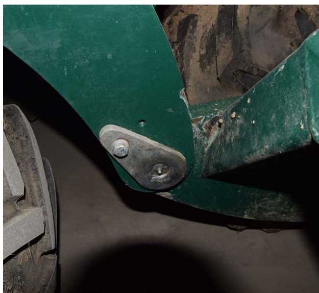
Rys. 10.14 Smarowniczka na sworzniach ramy wału tylnego
