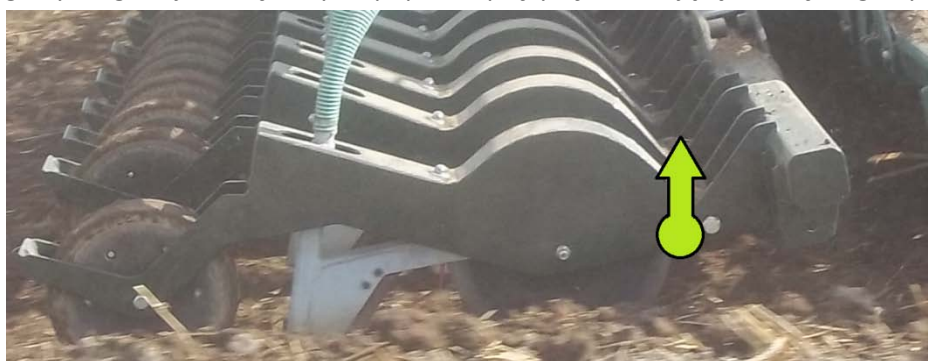
Rys. 7.5 Regulacja głębokości wysiewu
