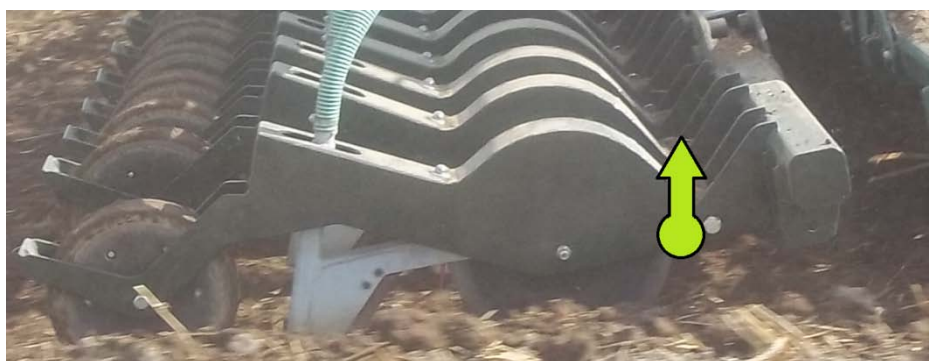
Rys. 7.7 Regulacja docisku redlic
