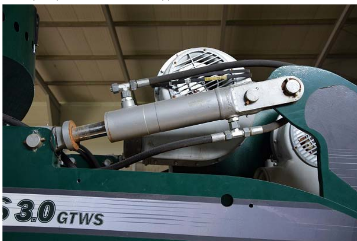
Rys. 6.5 Regulacja głębokości pracy agregatu na siłownikach łamania ramy.
