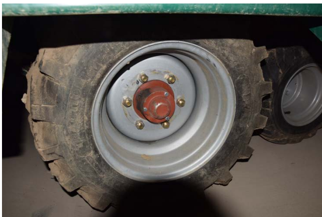
Rys. 10.12 Smarowniczka na piastach kół wału oponowego tylnego
