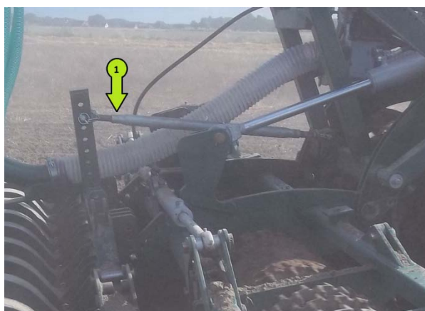
Rys. 7.6 Regulacja docisku redlic
