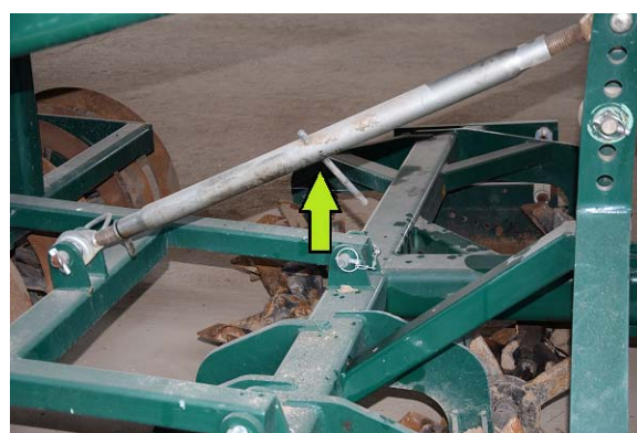
Rys. 6.13 Regulacja głębokości pracy kolczatki
