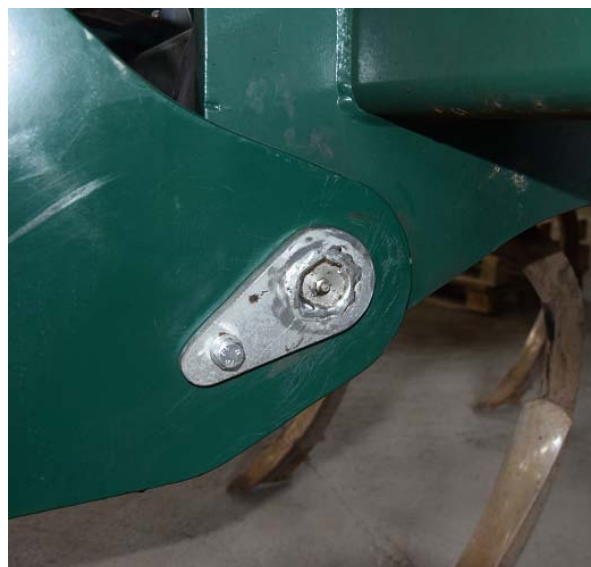
Rys. 10.3 Smarowniczka na sworzniach zaczepu
