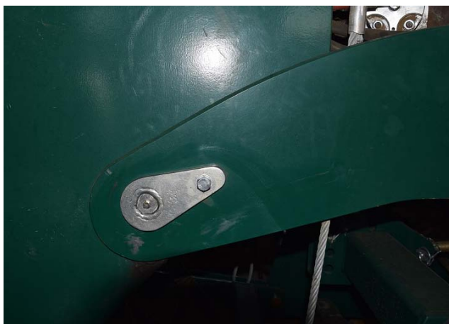
Rys. 10.5 Smarowniczka na sworzniach łączenia ram
